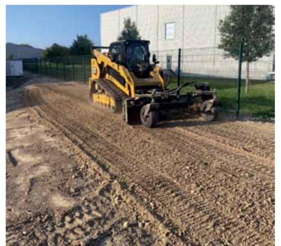
Ausgeprägtes Merkmal sind die bodenschonenden Gummiketten in Verbindung mit dem feingliedrigen Laufwerk, was die Baumaschine für Einsätze im Gala- und Sportplatzbau prädestiniert.
