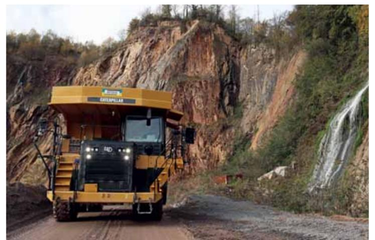
Nötig waren Anpassungen am Muldenkörper. So erhielt die Mulde eine Bordwanderhöhung und einen Überlaufschutz am vorderen Rand des Schutzdaches.
