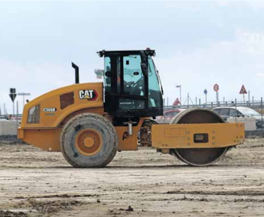
Cat Walzenzüge CS66B sorgen für die Verdichtung.
