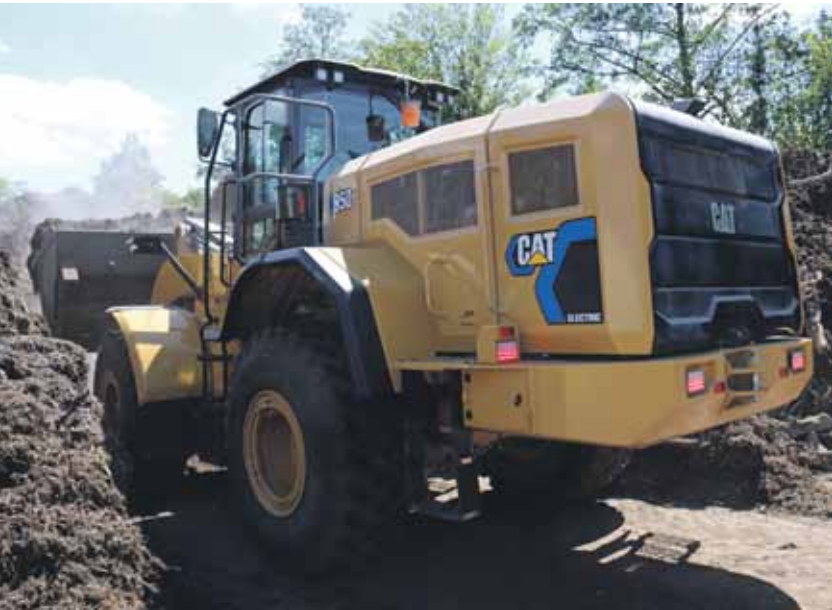
Mit ihrer vier Kubikmeter großen Hochkippschaufel fährt der Radlader in die Haufwerke und beschickt eine Siebanlage mit Gärresten. Fotos: Zeppelin
