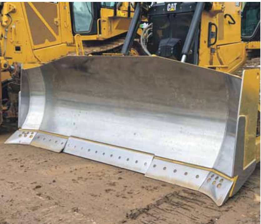
Die neuen Semi-U-Schilde (SU) für die Cat Raupen D6 und D6XE LGP sollen die Vorteile des LGP-Laufwerks erhalten und gleichzeitig deutlich mehr Material vor dem Schild halten.
