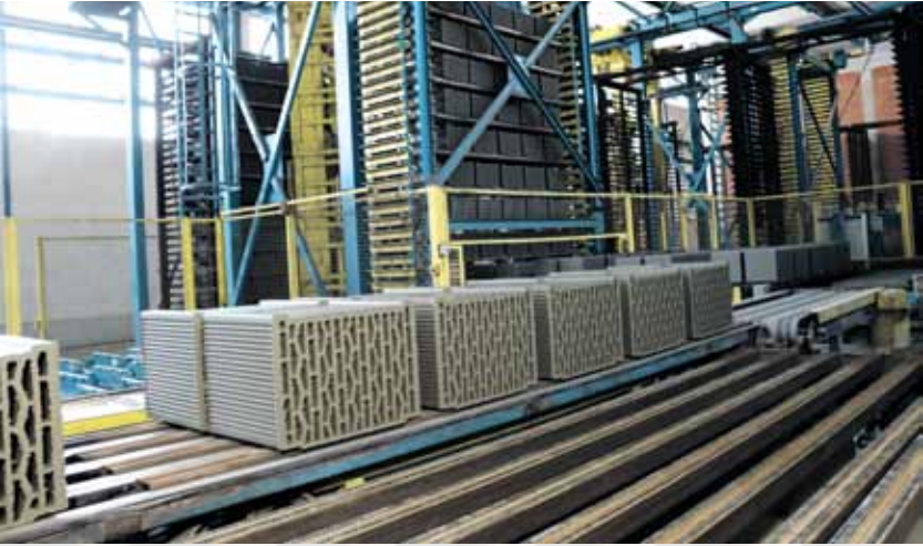
Die noch feuchten und empfindlichen Rohlinge werden auf Transporthilfen abgelegt und der Trocknung zugeführt. Erst dann gelangen sie zum Brennen in den Tunnelofen. Fotos: Zeppelin
