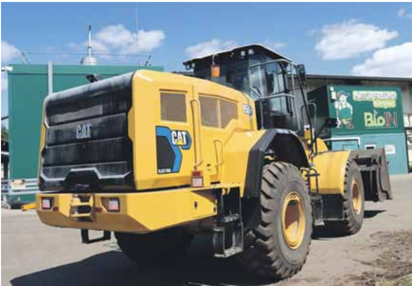
Der batterieelektrische Radlader ist im hinteren Bereich aufgrund seiner Batterien um 33 Zentimeter länger.
