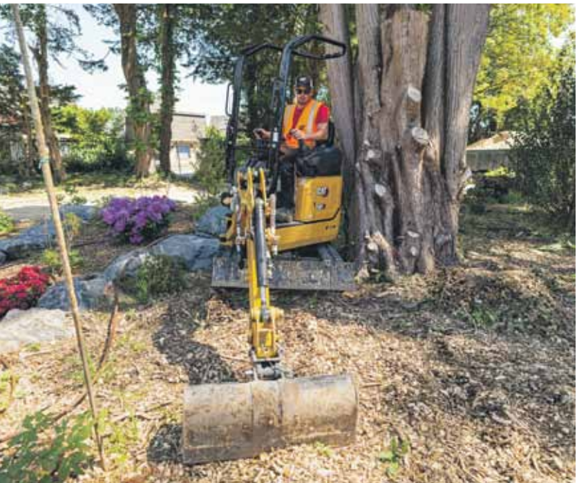
Seine kompakte Bauweise reduziert dabei den Überstand der Maschine und erleichtert Arbeiten unmittelbar neben Mauern und anderen festen Strukturen. Das Fahrwerk lässt sich von 1 100 auf 730 Millimeter Breite einziehen.
