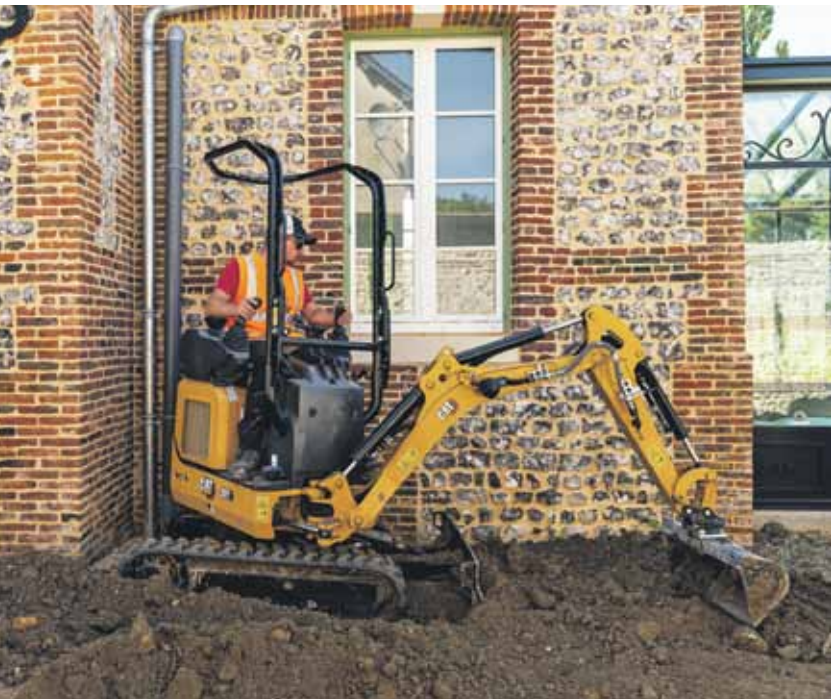
Seine kompakte Bauweise reduziert dabei den Überstand der Maschine und erleichtert Arbeiten unmittelbar neben Mauern und anderen festen Strukturen. Das Fahrwerk lässt sich von 1 100 auf 730 Millimeter Breite einziehen.
