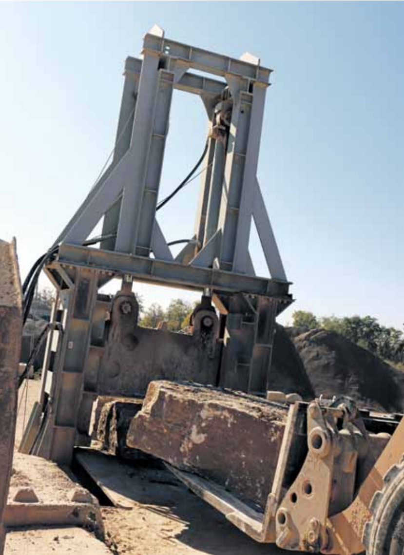
Muschelkalkblöcke trennt der Steinknacker mit seinem Messer.
