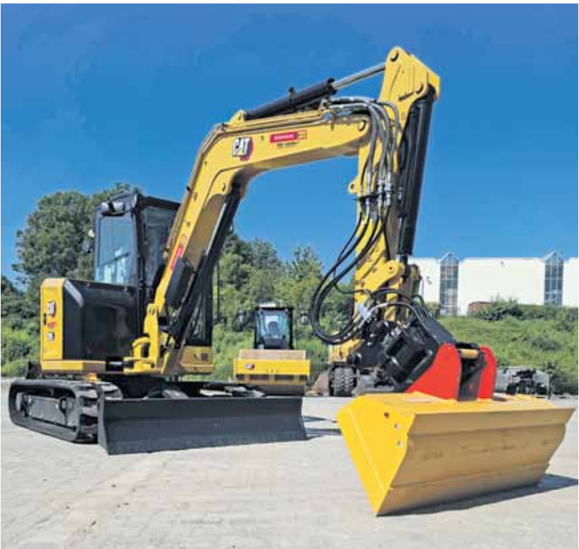
Der Cat Minibagger 305 CR überzeugt mit Oilquick-45-Schnellwechselsystem, Power Tilt und Kurzheckbauweise. Foto: Zeppelin Rental
