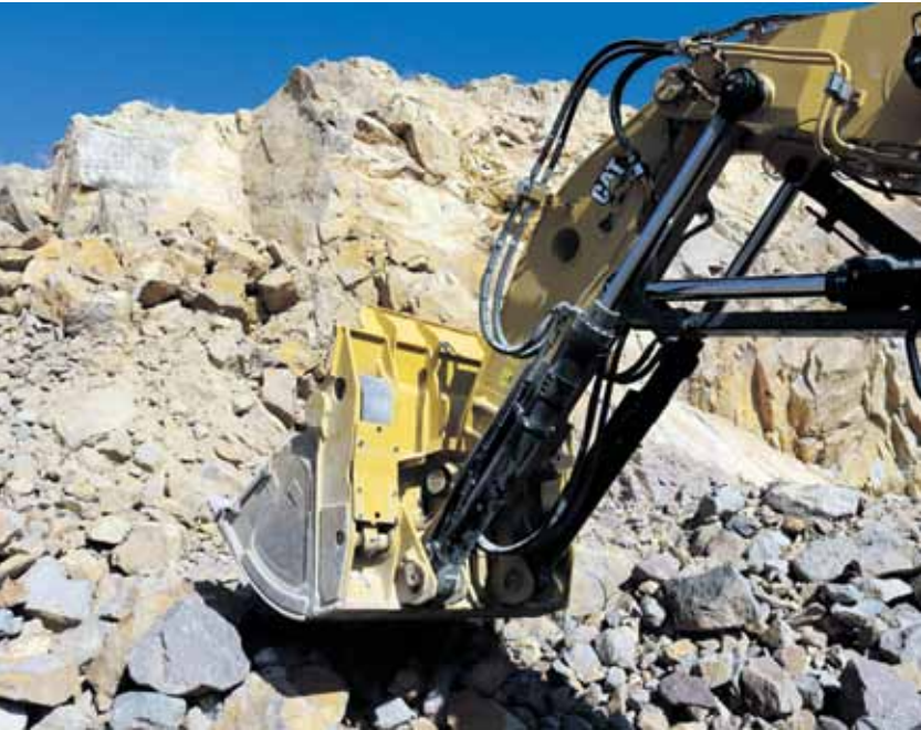
Die 5,2 Kubikmeter groe Hochklappschaufel wurde zustzlich verstrkt.
